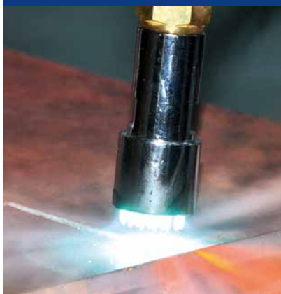
Mehrfammenbrenner Multi flame heating torch
